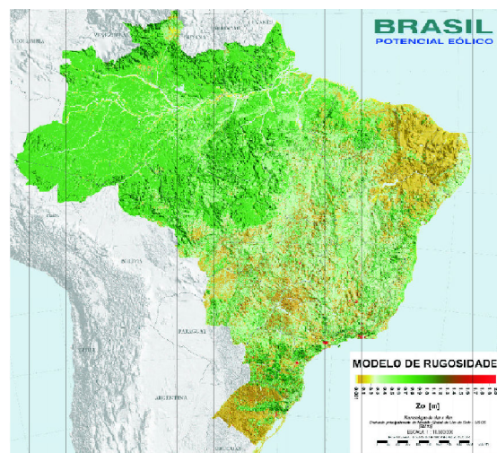
Figura 6.5. Modelo de rugosidade sobreposto ao relevo sombreado. Fonte: Atlas do Potencial Eólico Brasileiro, 2001.
