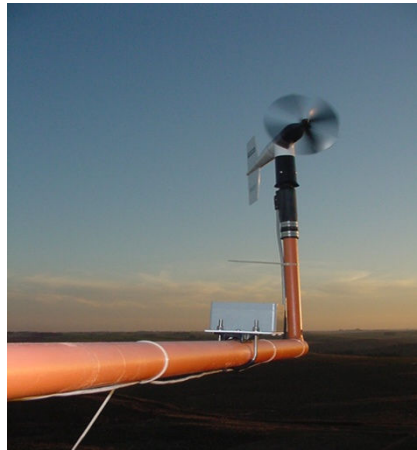
Figura 8.2. Equipamento de medida de dados eólicos da estação de referência SONDA – SMS, instalada no Observatório Espacial do Sul – OES/CRS/CCR/INPE – MCT.
